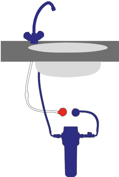
1. Drehe das Eckventil für kaltes Wasser zu. Es darf sich kein kaltes Wasser mehr aus der vorhandenen Armatur entnehmen lassen. Entferne die Kaltwasserzuleitung der Armatur vom Eckventil. Nutze im Zweifel die Dienstleistung eines Fachmanns.
